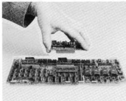
Afb. 1. Een single board computer, voorzien van twee speciale connectoren, waarop de nieuwe multimodulen kunnen worden aangebracht.
